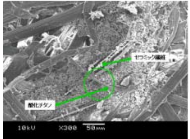
図6 抄紙機による酸化チタン担持シートの電子顕微鏡写真 2
