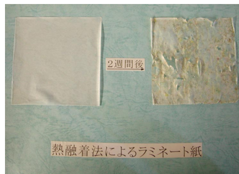
写真1 熱融着法によるラミネート紙の土壌埋設前後
