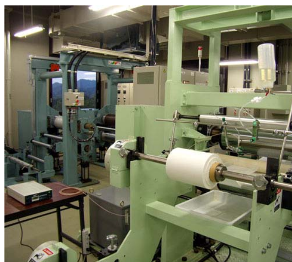
図4 超音波霧化塗工状況
